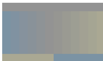
In einem kleinen Farbraum (hier sRGB) ergeben die Stufen eines Farbverlaufs auch bei geringer Bittiefe eher kleine Unterschiede.
